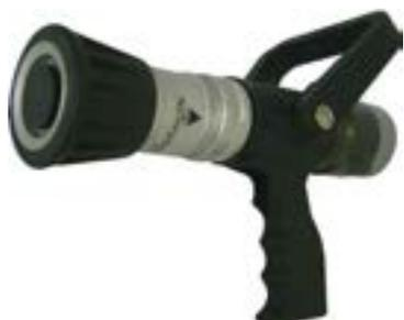
Costruita interamente in lega di alluminio, ha il bocchello rivestito in gomma antiurto con le indicazioni dell'angolo di apertura del getto. Valvola di intercettazione a sfera azionata con maniglia per una facile manovrabilità. Peso: 1250 g
