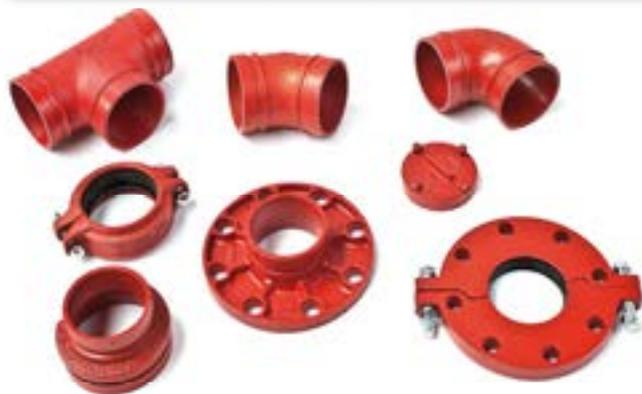
Il sistema di collegamento con i giunti consente un montaggio autocentrante sul tubo. Il guscio racchiude e trattiene la guarnizione, assicurando una perfetta tenuta alla pressione interna della tubazione. I bordi del corpo si innestano nelle scanalature eseguite alle estremità dei tubi impedendo la separazione determinata dall'effetto della pressione interna.
