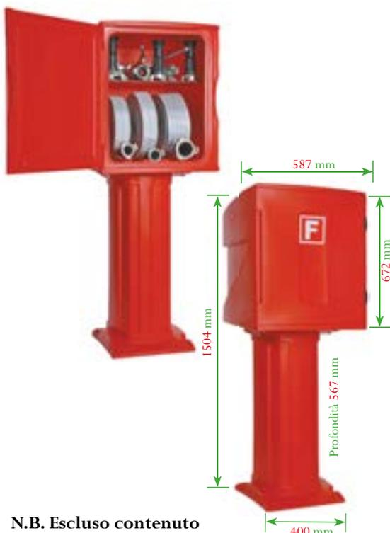
Cassetta da esterno per montaggio a terra, realizzata in polietilene a media densità resistente ai raggi ultra violetti (massima resistenza agli agenti atmosferici) di colore rosso RAL-3000. Cassetta con chiusura in plastica in policarbonato con facile apertura. Portello a doppio guscio rinforzata con chiusura impermeabile e cerniera integrata al corpo con albero in acciaio inossidabile.
