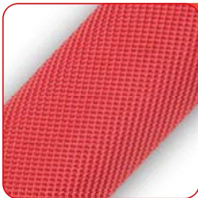
La tubazione antincendio JET ROUGE è composta da un tessuto circolare ad armatura diagonale di poliestere ad alta tenacità di colore rosso internamente impermeabilizzato con un tubolare prevulcanizzato di alta qualità e lunga durata perfettamente ancorato alla calza tessile.
