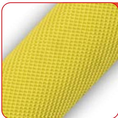
La tubazione antincendio JET FLUOR è composta da un tessuto circolare ad armatura diagonale di poliestere ad alta tenacità di colore giallo fluo internamente impermeabilizzato con un tubolare prevulcanizzato di alta qualità e lunga durata perfettamente ancorato alla calza tessile.
