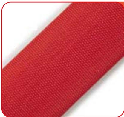
La tubazione antincendio RED KOBRA<sup>®</sup> è composta da un tessuto circolare di poliestere con un sottostrato impermeabilizzante elastomerico e con un rivestimento esterno in resina pigmentata di colore rosso. Il manto protettivo, perfettamente reticolato sulla calza tessile, ne esalta la resistenza all'abrasione, all'attacco batteriologico e a svariati prodotti chimici e la rende particolarmente adatta all'utilizzo in ambienti aggressivi.
