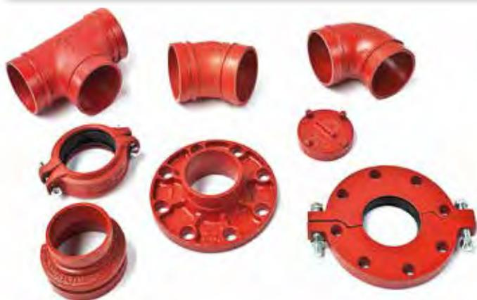
Il sistema di collegamento con i giunti consente un montaggio autocentrante sul tubo. Il guscio racchiude e trattiene la guarnizione, assicurando una perfetta tenuta alla pressione interna della tubazione. I bordi del corpo si innestano nelle scanalature eseguite alle estremità dei tubi impedendo la separazione determinata dall'effetto della pressione interna.
