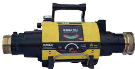
Sistema automatico di miscelazione per tutti i tipi di schiuma con miscelazione compresa tra lo 0,3% ed il 6%. Varie portate in unico miscelatore, si adatta automaticamente alla portata selezionata alla lancia. Portate comprese tra i 200 e 1.050 litri. Pressione di utilizzo tra i 5 e i 16 bar.
