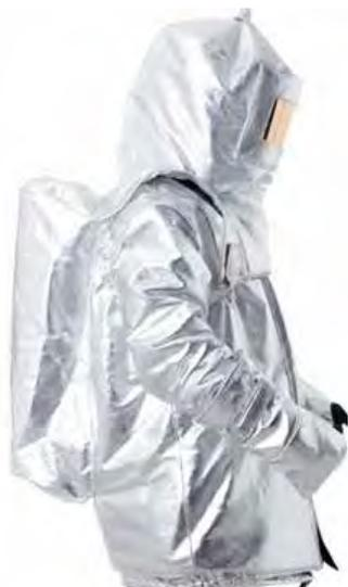
Il completo è realizzato con il tessuto para-aramidico preossidato da 485g/m<sup>2</sup> internamente coibentato con un doppio compound Barrier 845. Primo compound da 360 g/m<sup>2</sup> in fibra preossidata tre strati. Secondo compound da 360 g/m<sup>2</sup> in fibra preossidata tre strati con fodera con tela 50% meta-aramidica 50% viscosa FR da 125 g/m<sup>2</sup>.
