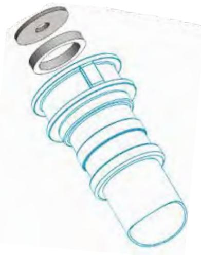
Diaframma calibrato in acciaio INOX con anello distanziale in teflon da installare sulla bocca degli idranti soprasuolo UNI70.
