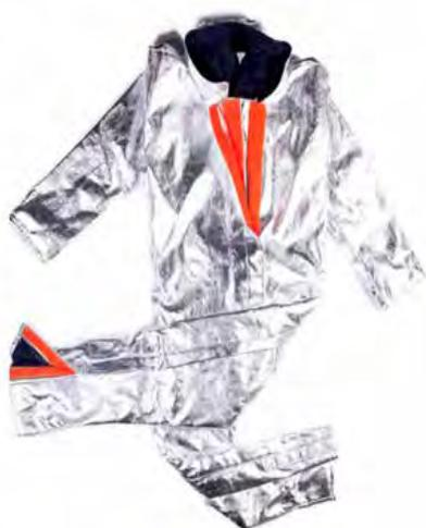
Il completo è realizzato con il tessuto para-aramidico preossidato da 485g/m<sup>2</sup> internamente coibentato con un doppio compound Barrier 845. Primo compound da 360 g/m<sup>2</sup> in fibra preossidata tre strati. Secondo compound da 360 g/m<sup>2</sup> in fibra preossidata tre strati con fodera con tela 50% meta-aramidica 50% viscosa FR da 125 g/m<sup>2</sup>.
