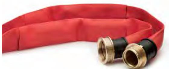
È consigliato come riparazione di emergenza l'utilizzo di uno spezzone lungo 60 cm (2 piedi) dello stesso diametro del tubo. Posizionarlo dalla più vicina estremità del tubo sul foro e mettere in pressione la tubazione. Lo spezzone aderirà al punto di foratura e consentirà la tenuta in pressione della tubazione ed una perdita minima.
