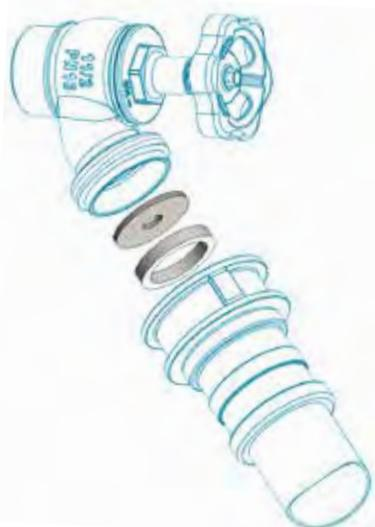
Diaframma calibrato in acciaio INOX con anello distanziale in teflon da installare sulla bocca dei rubinetti idranti DN UNI 45 - PN 25 (Art. **190PMAN** a pag.49).
