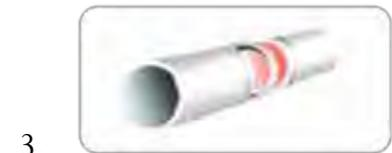
3. Far scorrere la guarnizione del giunto sulla scanalatura di un tubo
