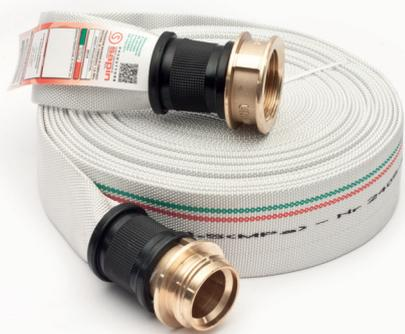
La manichetta UNIVIP – DN45, della famiglia KOBRA SAPIN e certificata UNI EN 14540, CSI n. DC03/041F04 registrazione n.2405/04, è composta da un tessuto circolare di poliestere ad alta tenacità con un sottostrato impermeabilizzante elastomerico. L'alta resistenza all'ozono ed all'invecchiamento la rendono la manichetta ideale per chiunque voglia un prodotto di lunga durata.
