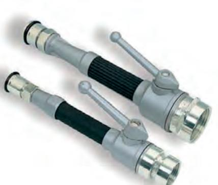
Lance avec combinaison de jet bâton avec écran d'eau. Elle permet d'attaquer le feu et de protéger en même temps le porte-lance. L'écran d'eau incorporé à la lance, assure en même temps la protection de l'opérateur contre la chaleur rayonnante et simultanément le jet bâton permet une attaque optimale du feu. Poids 1,450 g (2") ou 2,910 g (2" 1/2) sans raccord.
