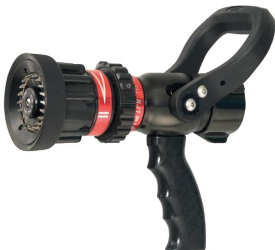
Lance sélectionnable conforme à la norme EN 15182-1 et 2. Construction légère solide en alliage d'aluminium avec une bague en caoutchouc pour une protection maximale et une meilleure prise. Sélection de l'angle de diffusion indiquée. La poignée pistolet ergonomique réduit l'effort du sapeur-pompier. Dents taillées inox, entrée tournante et vanne d'arrêt durable. Pour les articles 2078 (modèle 2360) et 2079 (modèle 2361) la pression de travail est de 40 bar.
