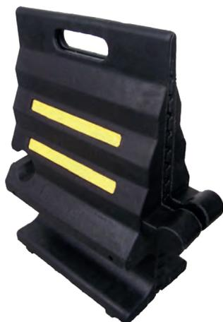
Pont en caoutchouc (max 13 tonnes par essieu) pour le passage des camions sur les tuyaux. 4 pièces sont nécessaires pour le passage du véhicule.
