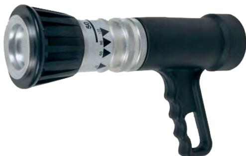
Lance polyvalente avec débit constant et un angle de diffusion réglable entre 30° et 120° pour renforcer l'effet d'extinction (jet plein, pulvérisation et brouillard d'eau). Construction légère solide en alliage d'aluminium avec une bague en caoutchouc pour une protection maximale et une meilleure prise. Sélection de l'angle de diffusion indiquée. La poignée pistolet ergonomique offre maniabilité et réduit l'effort de l'utilisateur. Poids 1050 g sans raccord.
