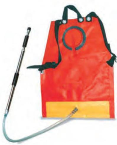
Dépôt flexible thermosoudé. Fabriqué en toile renforcée avec un tissu synthétique. De facile utilisation et de grande efficacité. Idéal pour la fin des travaux d'extinction d'incendies de forêt. Faciles à transporter et à stocker. Capacité 18 litres. Une pompe à piston à deux temps, réalisée en laiton chromé, permet un jet continu réglable à l'extrémité de la lance.
