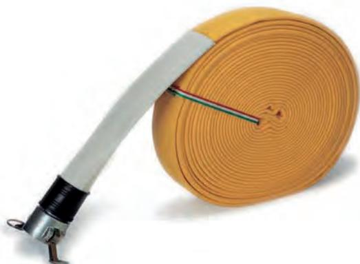
Pour augmenter la résistance du tuyau à proximité des raccords dans des conditions d'utilisation difficiles et intensives, il est suggéré d'utiliser des gaines de protection à proximité des raccords. Les normes nationales suggèrent une longueur de la gaine de protection de 10 fois le diamètre du tuyau.
